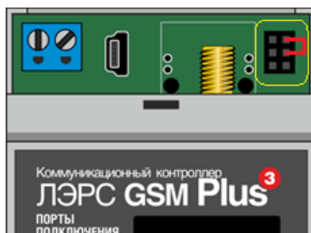
Рисунок 5.1 – Установка перемычки для обновления ПО
