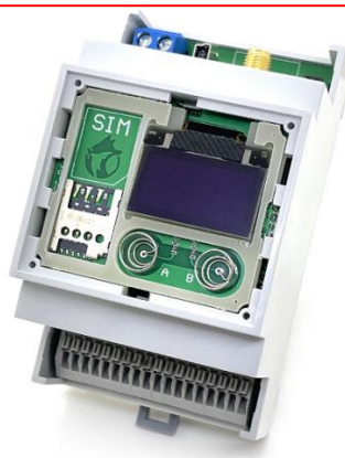
Рисунок 4.1 – Слот для установки SIM-карты под верхней крышкой
